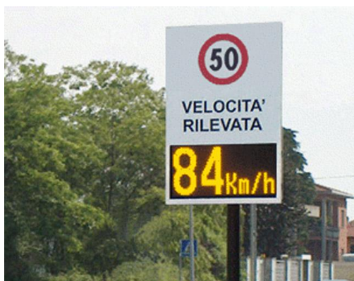
Figura 7 Pannelli misuratori di velocità (Speed Monitoring Display)
